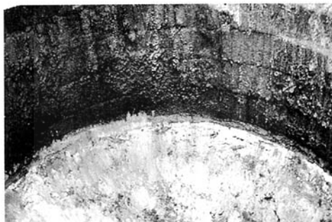
图 1 第 40 炉次时电弧炉内衬状态
